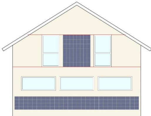
Abb. 32 Die Anlageteile richten sich an bestehenden Fassadenelementen aus und sind eingemittet, jedoch nicht gleichmässig angeordnet. Die Gesamtwirkung ist dennoch harmonisch.
