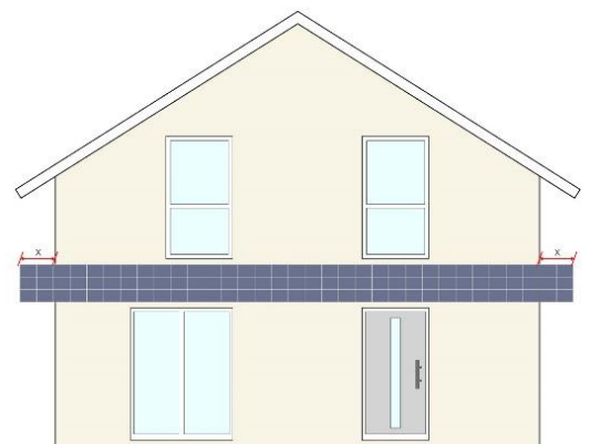
Abb. 4 Die Anlage ragt sowohl links als auch rechts über die Fassadenkante hinaus.
