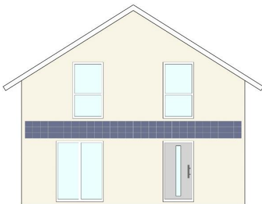
Abb. 3 Die Anlage überragt die Fassadenkanten nicht und ist eingemittet.
