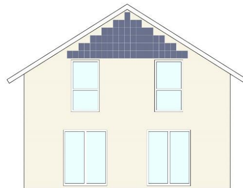
Abb. 29 Die Anlage ist treppenartig abgestuft und deckt die betroffene Giebelfläche nicht vollständig ab.
