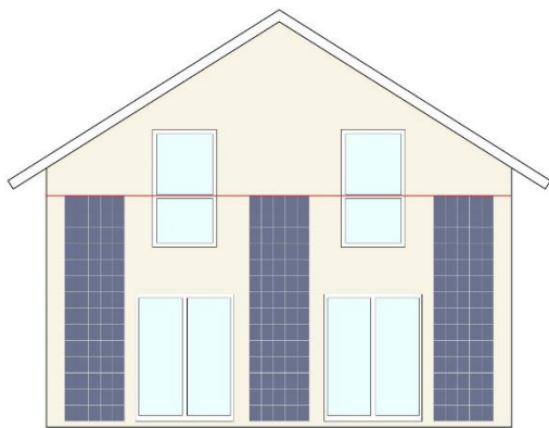
Abb. 8 Die Anlage weist eine einheitliche Farbgebung und Materialisierung auf und ist nach dem Stand der Technik reflexionsarm.
