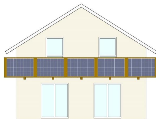
Abb. 25 Zwischen den Anlageteilen bestehen Zwischenräume. Die Anlage ersetzt oder überdeckt das Balkongeländer nicht einheitlich.
