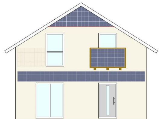
Abb. 35 Die Anlage besteht aus unterschiedlichen Teilflächen, die nicht aufeinander abgestimmt sind. Die Gesamtwirkung ist nicht harmonisch.
