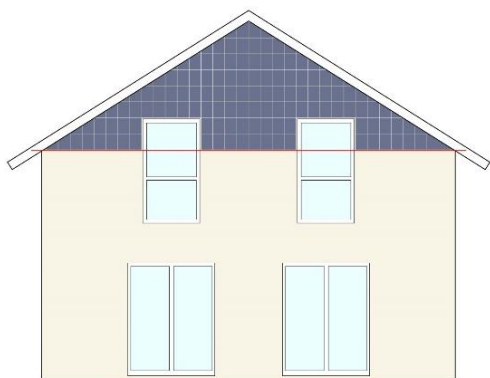
Abb. 26 Die Anlage deckt die betroffene Giebelfläche vollständig ab.
