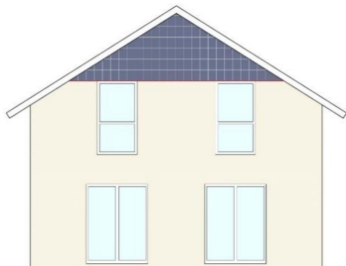
Abb. 28 Die Anlage deckt die betroffene Giebelfläche vollständig ab.
