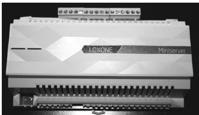
Kaum grösser als eine Getränkedose: Miniserver für die zentrale Steuerung der Heimtechnologien.
